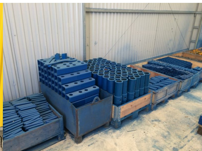
Nowe sworznie, łączniki i elementy rozpór
